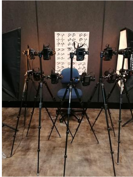
Figura 1. Sistema de fotogrametría utilizado para reconstruir los modelos faciales 3D a partir de diez fotografías digitales obtenidas de forma no invasiva.
